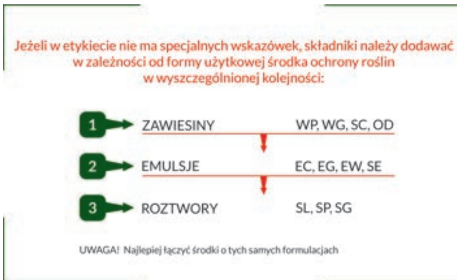
Ryc. 6. Kolejność dodawania składników podczas tworzenia mieszanin zbiornikowych w zależności od ich form użytkowych
