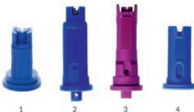
Fot. 7. Rozpylacze eżektorowe jednostrumieniowe różnych producentów (1. i 4. w wersji kompaktowej, 2. i 3. w wersji standardowej)
