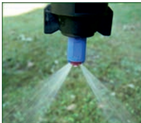
Fot. 8. Rozpylacz eżektorowy dwustrumieniowy w trakcie pracy
