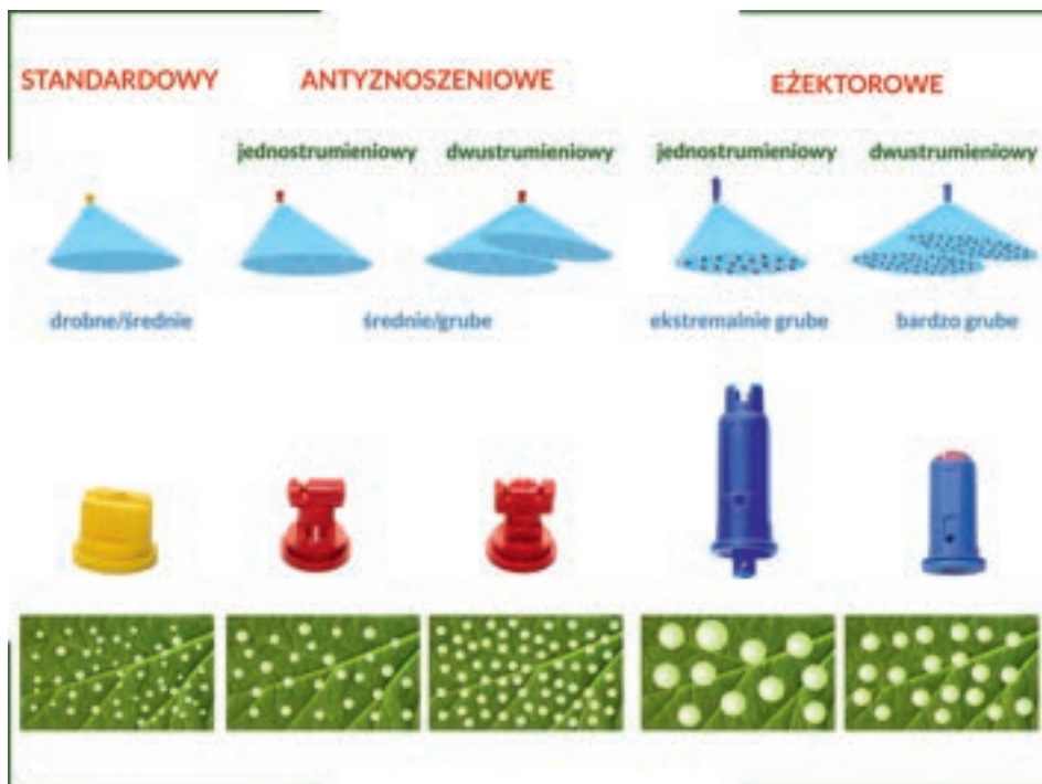
Ryc. 4. Typy rozpylaczy szczelinowych
